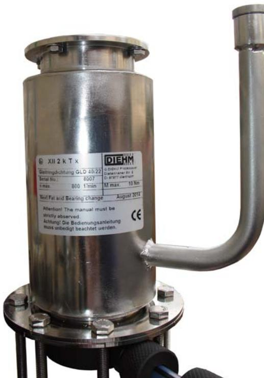
Alle Gleitringdichtungen haben ein doppeltes Dichtsystem, so dass zum Produktraum und zum Lagergehäuse abgedichtet wird. Das Gehäuse ist wassergekühlt und kann sich somit weder durch die Prozesstemperatur, noch durch die Reibungstemperatur nennenswert aufheizen.
